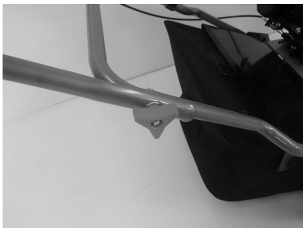
Montaż górnego segmentu rękojeści
