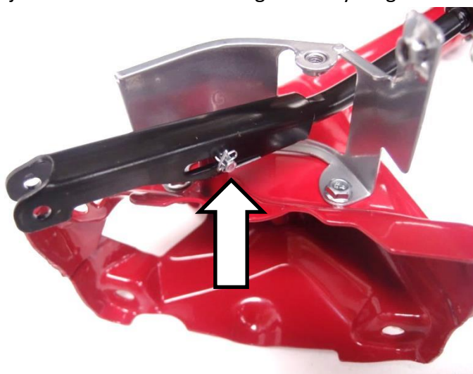
zdj. 10 HGS 500 Montaż dźwigni zmiany biegów. Zatyczką mocujemy dźwignię do wspornika rękojści.
