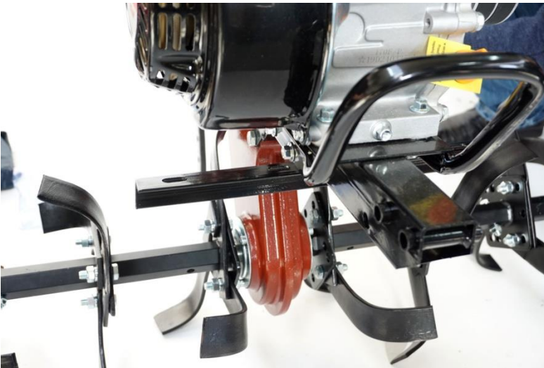
Zdj. 7. HGS 900 Montaż przedniego wspornika osłon.
