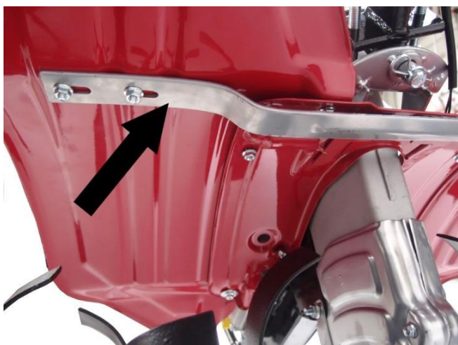
zdj. 19 HGS 500 Montaż osłon bocznych Pod osłonami montujemy wspornik, przykręcając go na 2 śruby do lewej i 2 śruby do prawej osłony
